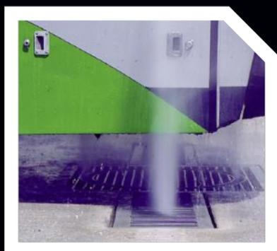
Проездная мойка днища с фиксированными форсунками
