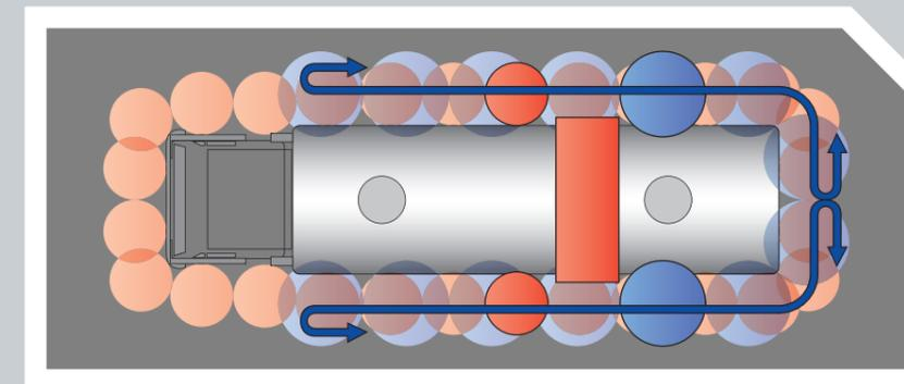
Алгоритм движения 4-х боковых щеток при мойки цистерн
