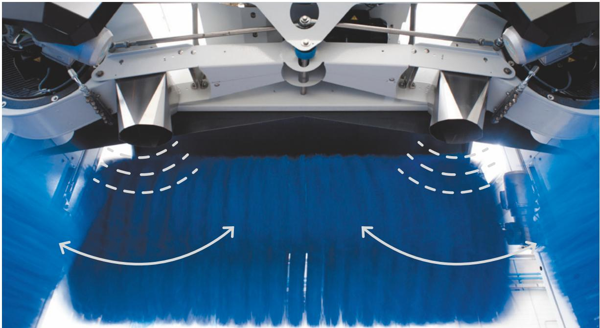
Верхние сушильные аппараты создают пульсирующие потоки воздуха с эллиптической траекторией, оптимальной для естественного вытекания воды под машину, а затем на землю: это гарантирует отличную комбинацию между мойкой и сушкой.
