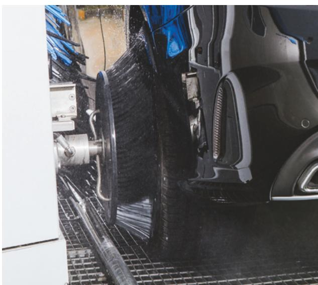
Система **Wheel Master** предназначена для мойки колес, а также боковой и нижней части автомобилей. Она оснащена **двумя форсунками высокого давления**. Благодаря превосходной комбинации силы высокого давления и мягкости щеток, система Wheel Master обеспечивает **отличные результаты мойки даже в труднодоступных местах**.
