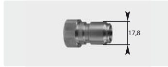
Штекер : IG. Нерж. сталь. Макс. 250 bar / 150 °C
