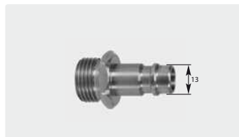
Штекер : AG. Нерж. сталь. Макс. 150 bar / 90 °C
